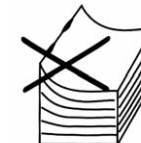
Papier zu dünn - Klammerung trägt auf
